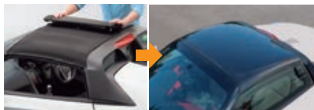
ヤチヨブランドの商品として発売を目指す軽量カーボンルーフは、純正ルーフ(幌タイプ)に対し約20%軽量
